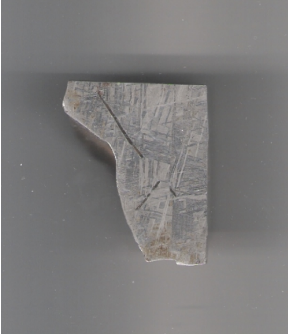
Şekil-5. Akyumak,III-a Demir Meteoriti. Taklit Edilemeyen Kristal Yapısı. (U.Kaynak Koleksiyonu)
