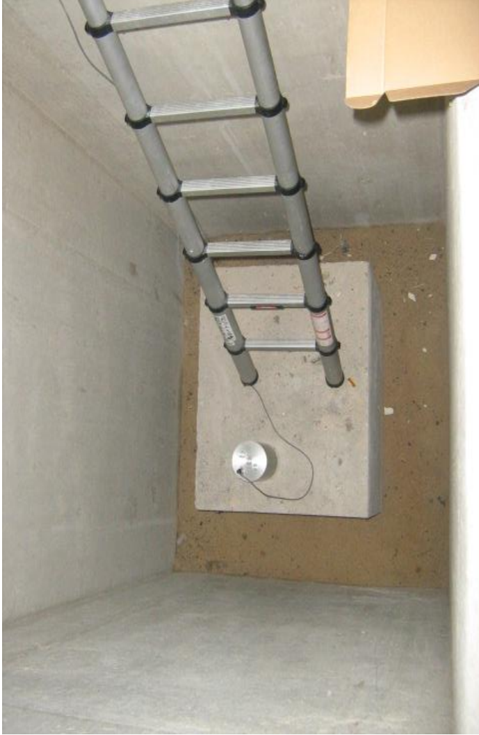
Şekil 48. Sismik çukur, pilye ve sismometre
