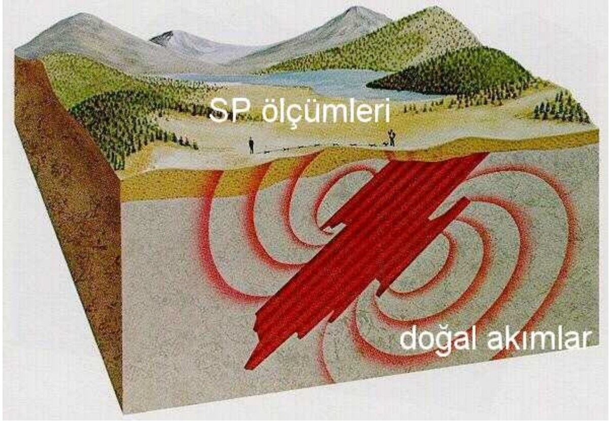
Şekil 4: Depreme aday yeraltı kesimindeki basınç-gerilim nedeni ile artan su akışmaları doğal bir elektrik akımı meydana getirir
