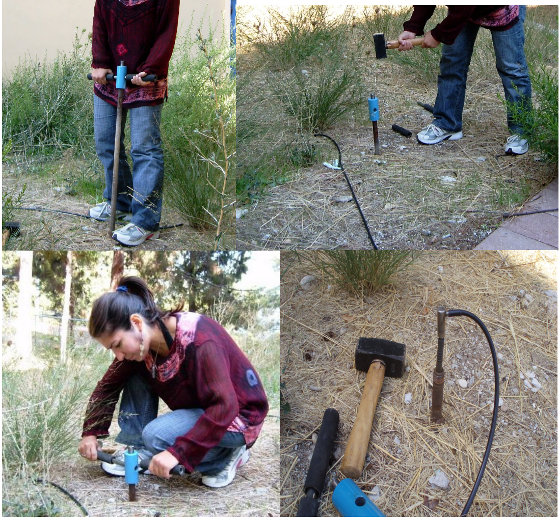
Şekil 3.14. Toprak gazı sondasının ölçüm alanına yerleştirilmesi
